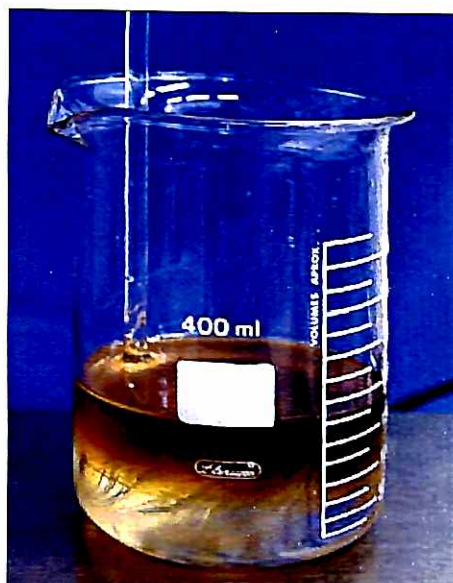
Figura 5 – Resina fotoelástica vertida em um béquer, sendo espatulada com um bastão de vidro
