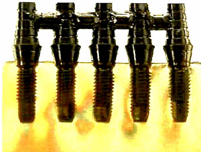
Figura 28 – Supra-estrutura parafusada com aplicação de carga
