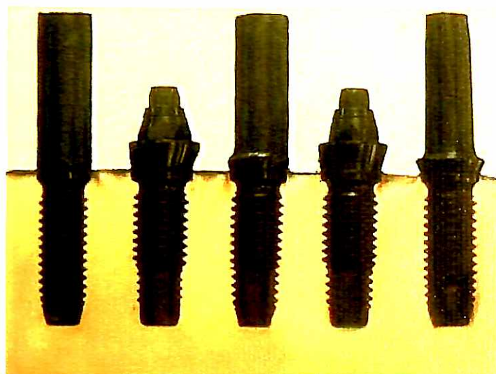
Figura 25 – Pilares esteticone e de preparo – Torque de 20 N.cm
