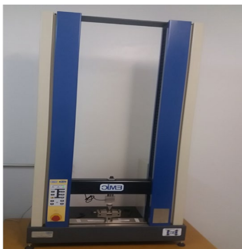
Figura 5: Máquina de ensaio universal. EMIC.
