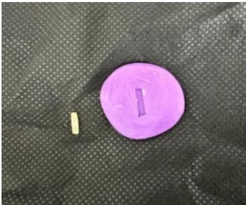
Figura 2. Espécime piloto (Z250 3M) e matriz de silicone de adição (XT Express 3M) pesada confeccionadas para padronização das amostras.
