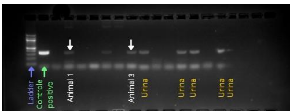
Figura 1. Gel de agarose demonstrando amplificação de DNA leptospírico em amostras de sangue dos animais 1 e 3.
