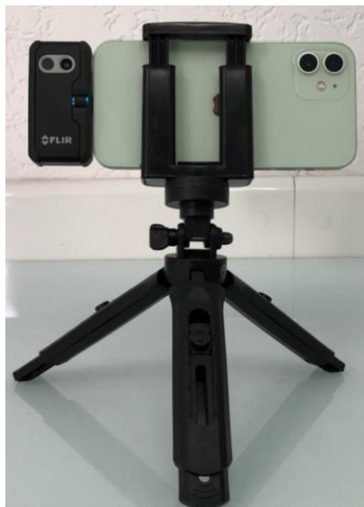
Figura 12 – Suporte tripé utilizado para aferição térmica com a câmera termográfica infravermelha conectada ao smartphone.
