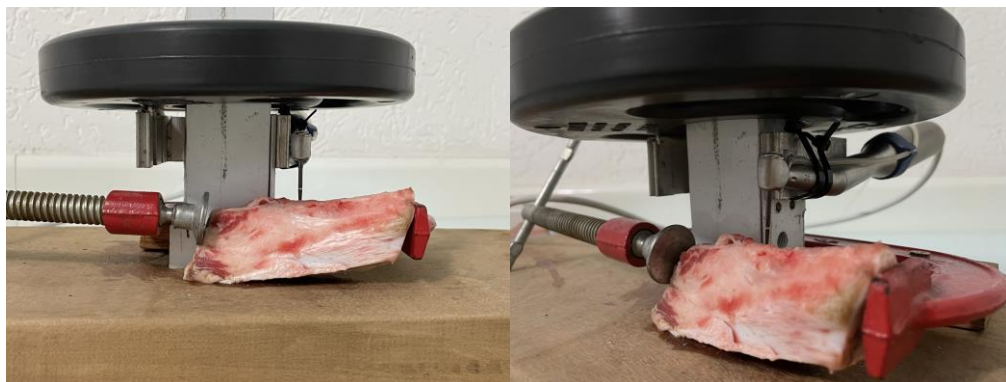
Figura 6 – Suporte confeccionado para padronizar as perfurações com carga axial de 2Kg.
