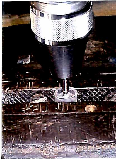
Figura 3 - amostra fixada na morsa quando da aplicação do torque
