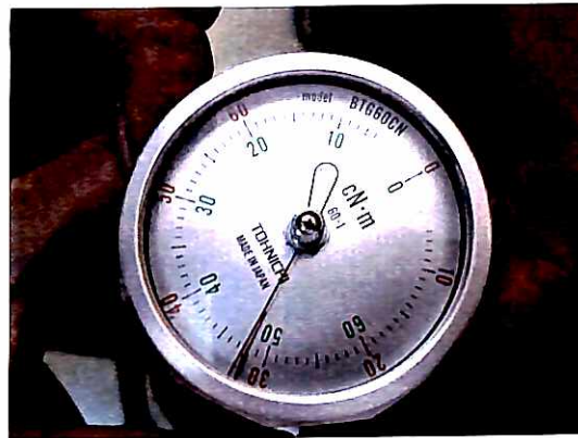
Figura 4 - torque de 32 Ncm recomendado pelo fabricante
