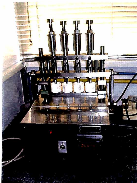
Figura 6 - máquina de ciclagem mecânica e amostras distribuídas em grupos de quatro
