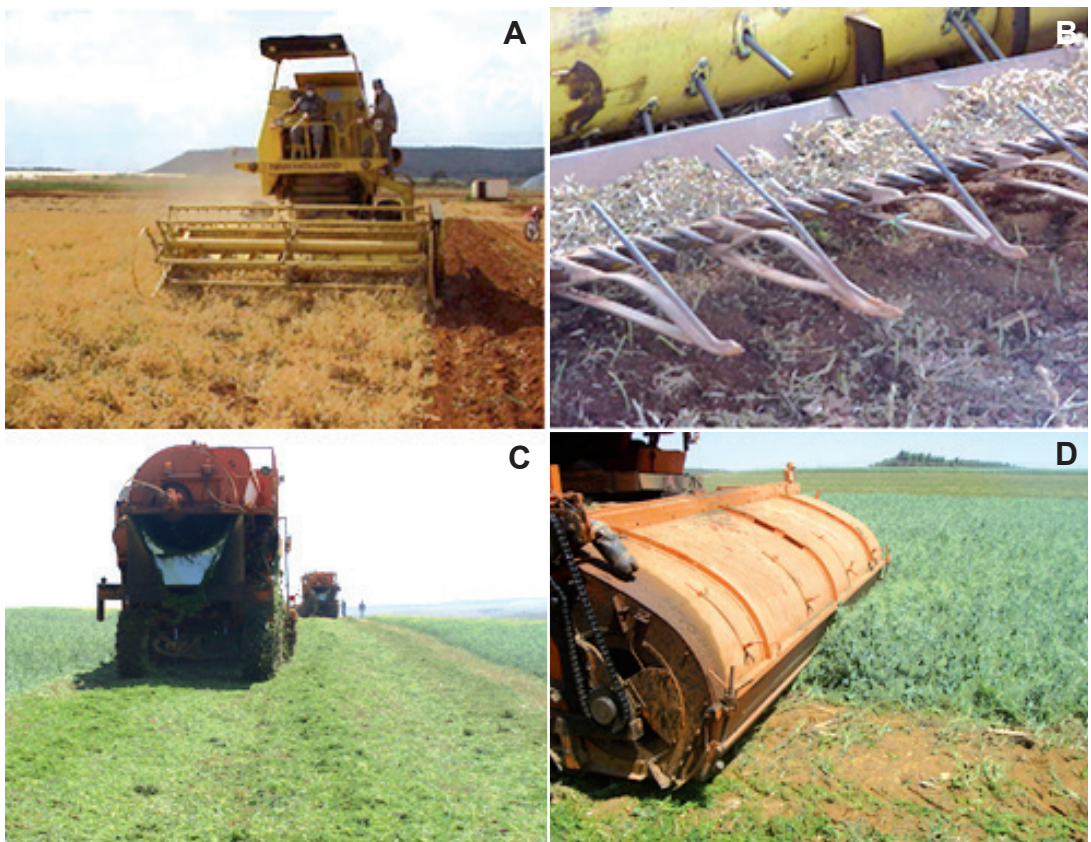
Figura 25. Colheita de grãos secos (A) e detalhe da plataforma de corte (B); colheita de grãos verdes (C) e detalhe da máquina de colheita de grãos verdes (D).
