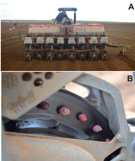
Figura 11. Plantio de grão-de-bico utilizando plantadeira de precisão (A) e detalhe do disco (B).
