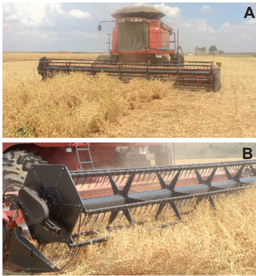
Figura 22. Colheita de grão-de-bico utilizando colheitadeiras de cilindro axial (A) e detalhe da plataforma de corte e molinete (B).
