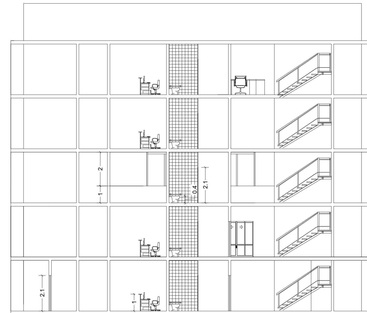
CORTE B EDIFÍCIO COMERCIAL E CORPORATIVO ESCALA 1/100
