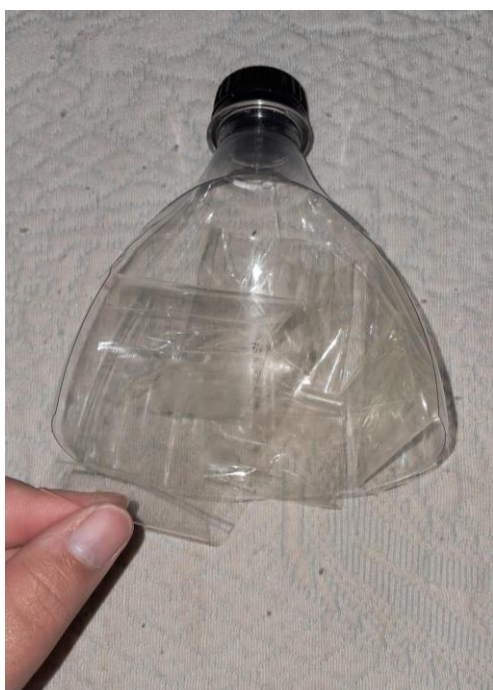
Aplicação da fita adesiva na parte interna do filtro. Fonte: Autoria própria.
