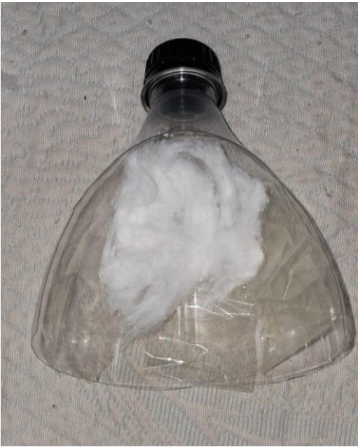
Processo inicial de colagem do algodão no filtro. Fonte: Autoria própria.
