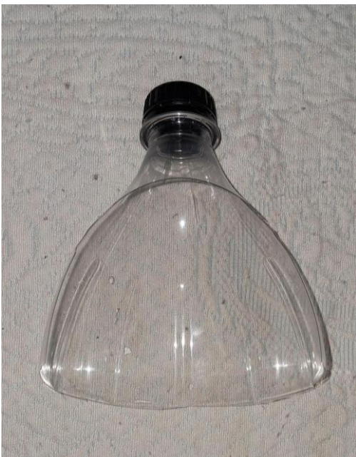
Figura 6 – Corte em formato de "iglu" na parte do ombro da garrafa, formando a entrada do filtro.
