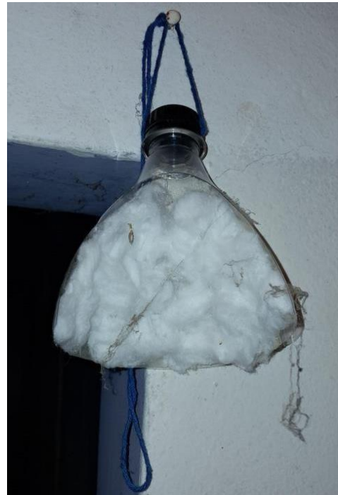
Filtro interno após um mês de exposição. Fonte: Autoria própria.
