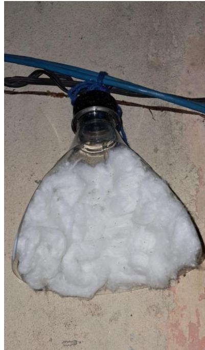
Filtro do quintal após um dia de exposição. Fonte: Autoria própria.
