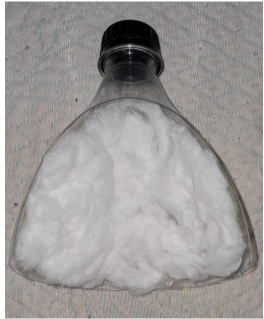
Filtro com a colagem do algodão finalizada. Fonte: Autoria própria.
