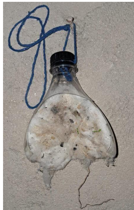
Filtro da rua após um mês de exposição. Fonte: Autoria própria.
