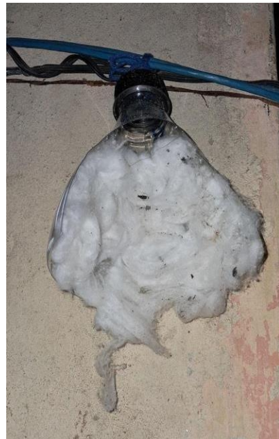
Filtro do quintal após um mês de exposição. Fonte: Autoria própria.
