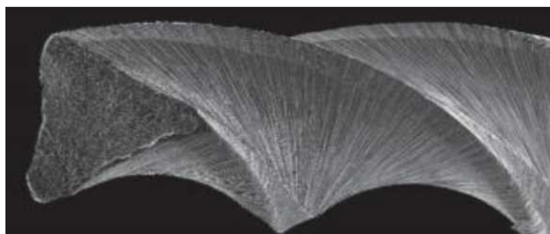
Figura 2. Fratura por flexão rotativa. Ausência de deformação plástica das hélices
