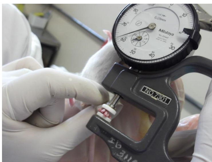
Figura 6 - Método de aferição da espessura da pata com micrômetro.
