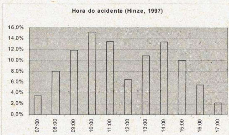
Figura 19 Hora do acidente na construção civil em Washington, EUA (Hinze, 1997)
