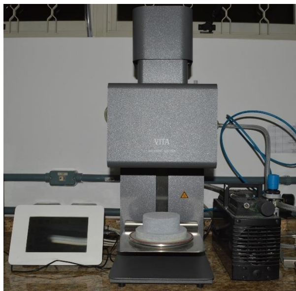
Figura 6 - Forno VACUMAT 6000 MP para cristalização dos espécimes ZLS2 e das queimas de caracterização e glaze de todos os espécimes
