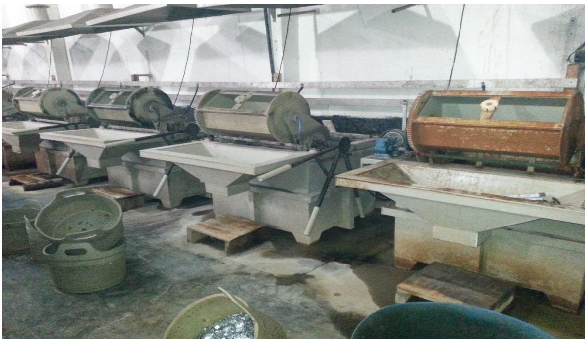
Figura 15 – Tanques de deposição de Zinco Rotativo.
