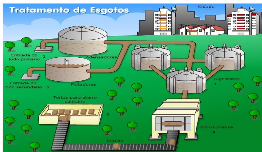
Figura 17 – Esquema para tratamento de Esgoto.
