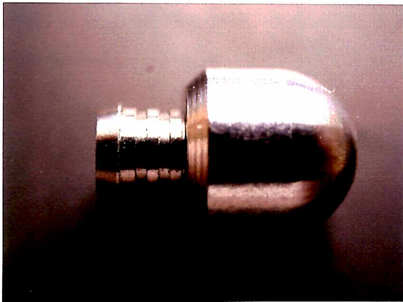
Figura 01 - Cilindro de titânio com a esfera torneada
