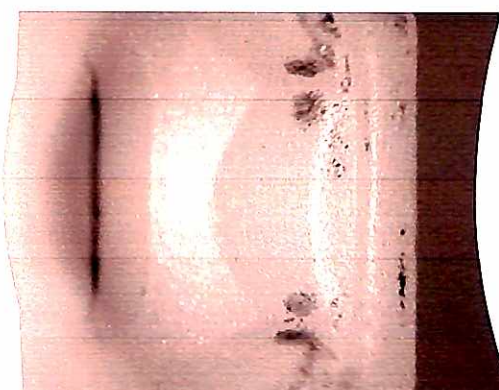
Figura 36 – Hexágono de um abutment após um milhão de ciclos do grupo seco nº4 (aumento de 100x)
