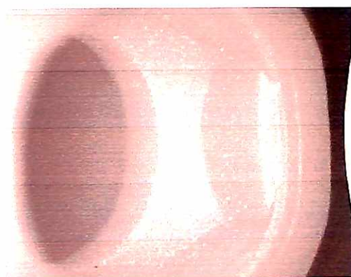
Figura 35 – Hexágono de um abutment novo (aumento de 100x)
