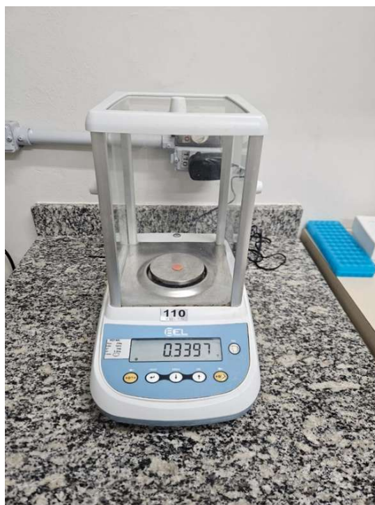
Figura 8: Balança de precisão utilizada para obtenção dos valores de massa
