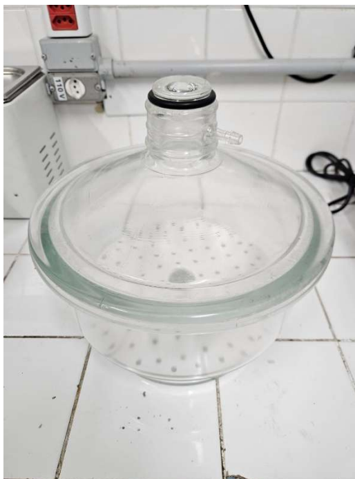
Figura 9: Dessecador utilizado para desidratação dos espécimes
