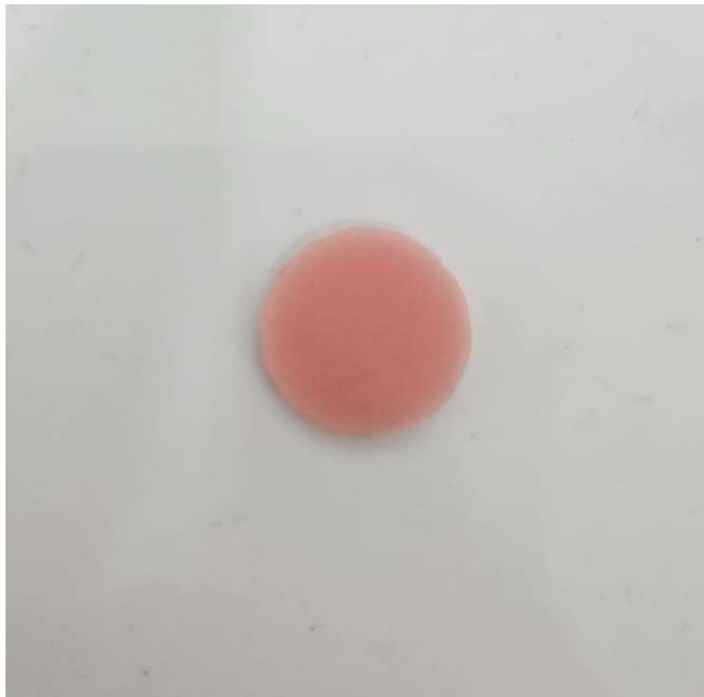
Figura 1: Amostra utilizada para ensaios de microdureza, sorção e solubilidade
