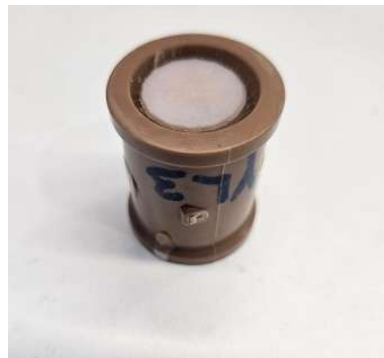
Figura 4: Amostra incluída em tubo de PVC
