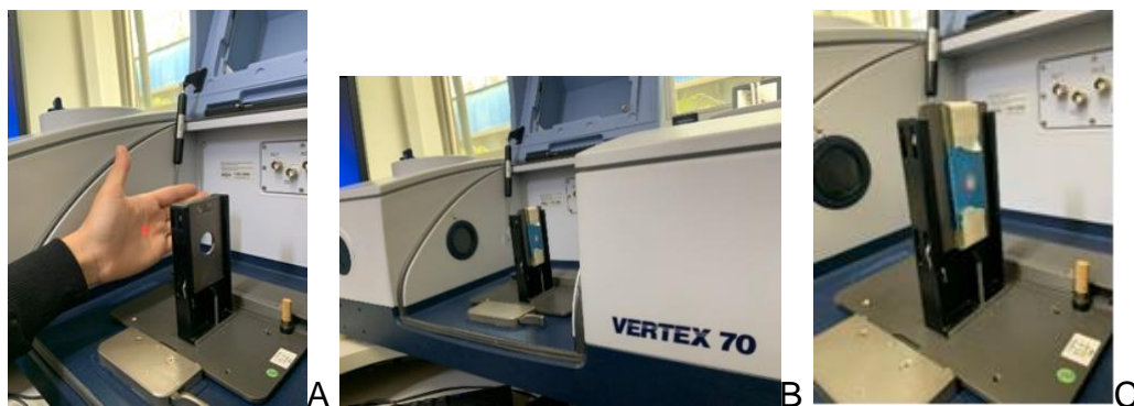
Figura 4: (A) Luz Guia; (B) Conjunto matriz/compósito posicionado para a leitura; (C) Vista Ampliada.
