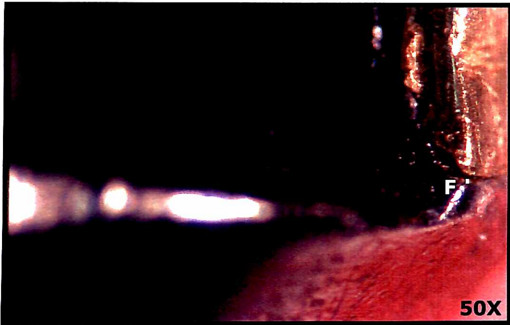
FIGURA 24 – GES – CP 1 - Ponto F - Média de discrepância : 10 \mu m
