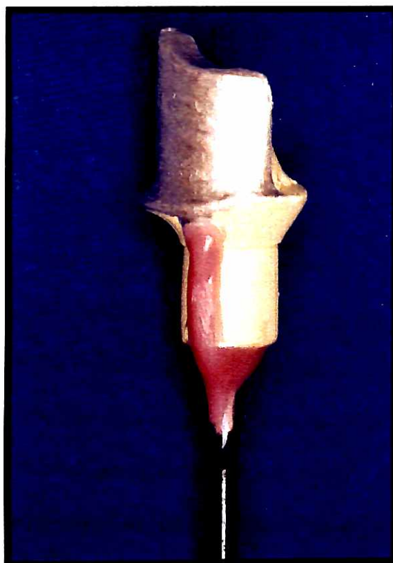
FIGURA 8 – Fio de cobre colado ao duplicado com a laca de prata aplicada
