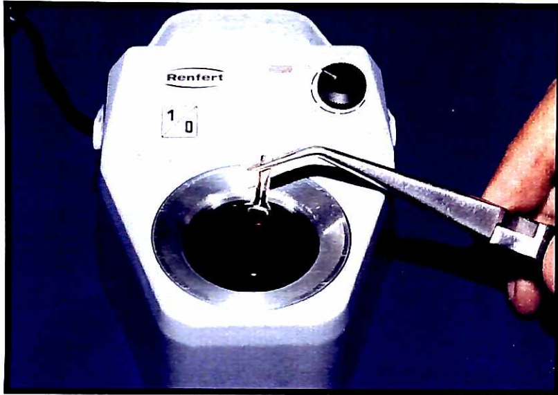
FIGURA 13 – Imersão do pilar personalizado no aparelho para fundir cera
