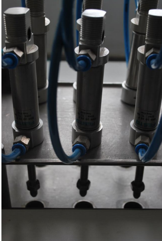
Fig. 25 – Vista aproximada da relação dos pistões com o encaixe para as bases cilíndricas em alumínio para os corpos de prova
