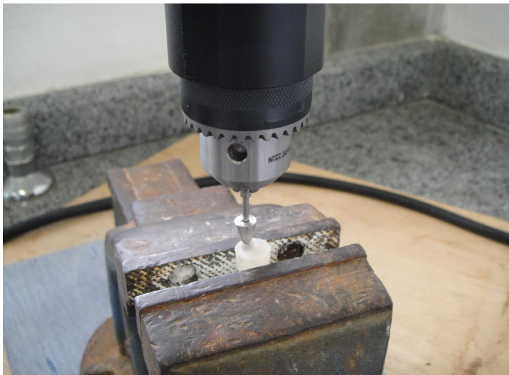
Fig.15 – Conjunto implante/pilar incluído em resina acrílica preso por uma morsa de bancada para que fosse aplicado o torque de apertamento do parafuso do pilar a 32N.cm.
