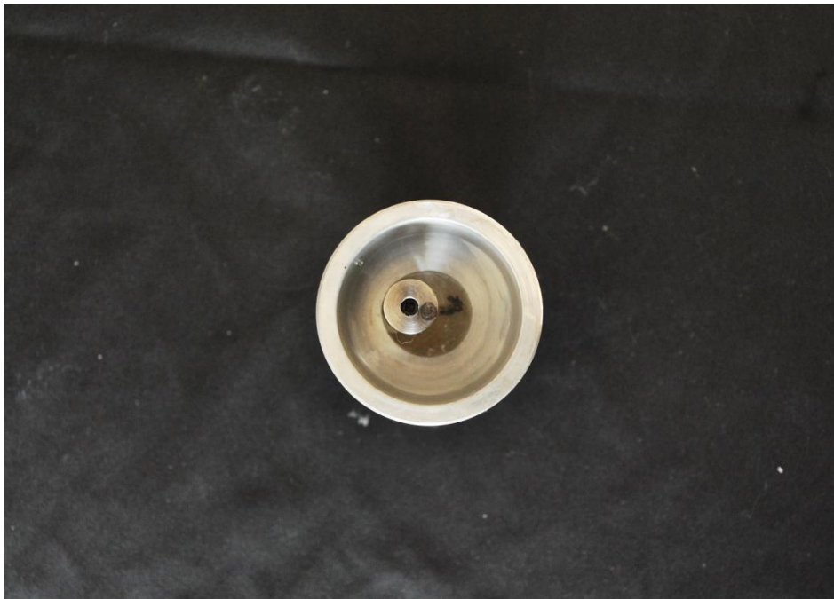
Fig. 21 – Vista oclusal de corpo de prova do grupo teste em seu respectivo cilindro de alumínio, após ensaio de ciclagem
