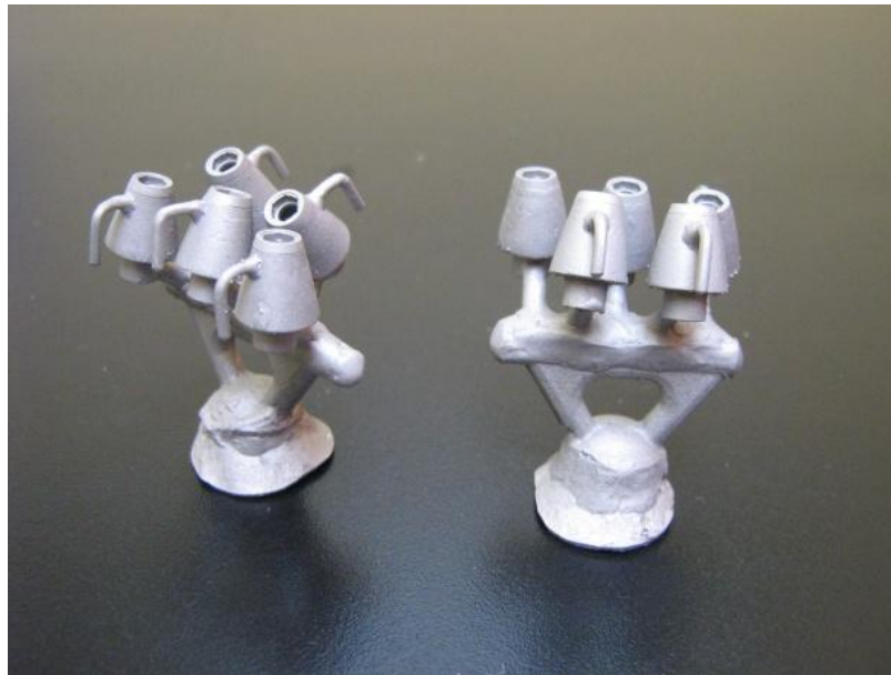
Fig. 2 - Pilares após a fundição
