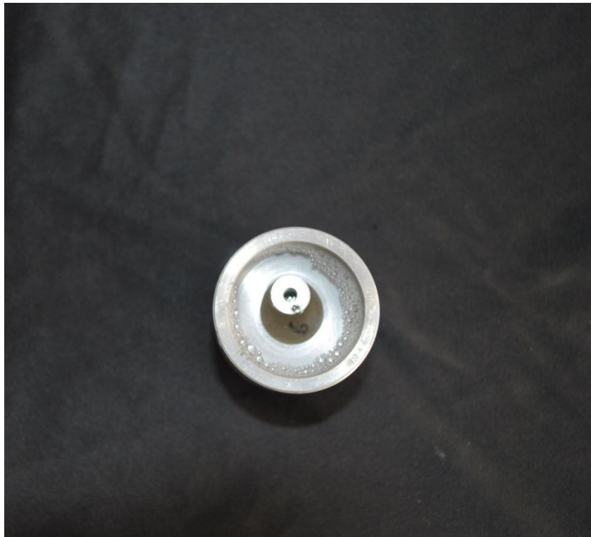
Fig.28 – Solução de saliva no interior do cilindro de alumínio, embebendo o corpo de prova.
