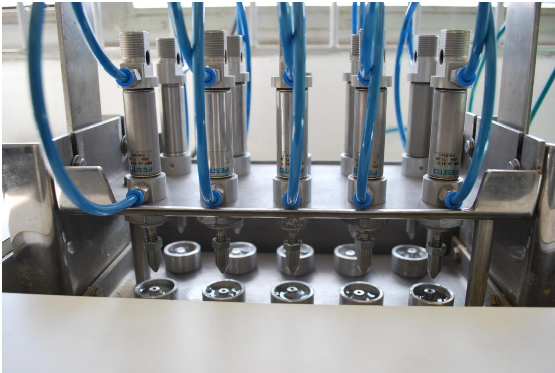
Fig. 26 – Vista das pontas dos pistões recolhidas com os corpos de prova devidamente posicionados.
