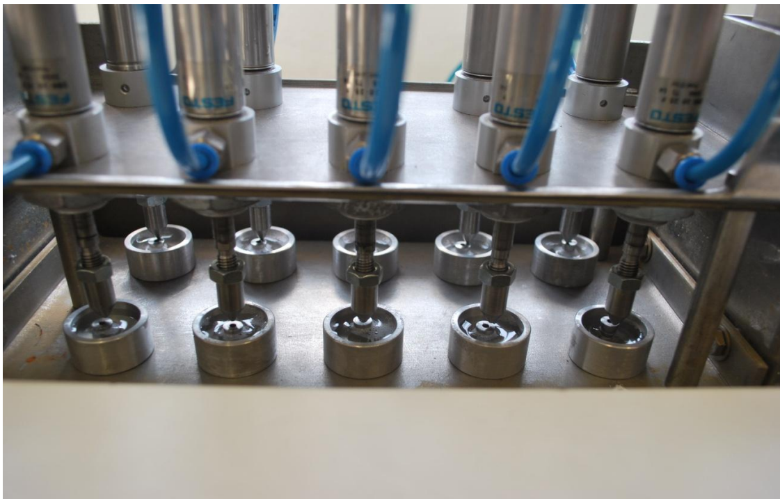
Fig. 27 – pontas dos pistões entrando em contato com os corpos de prova
