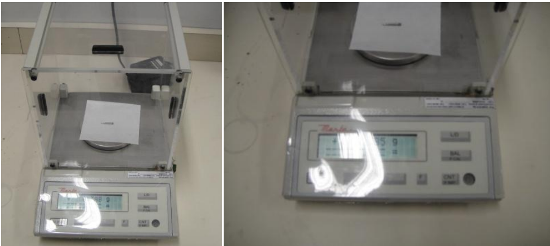
Fig. 17a e 17b – Balança de precisão medindo a massa da pasta de vedação.
