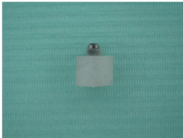
Fig.6 - Implante incluído em resina acrílica incolor
