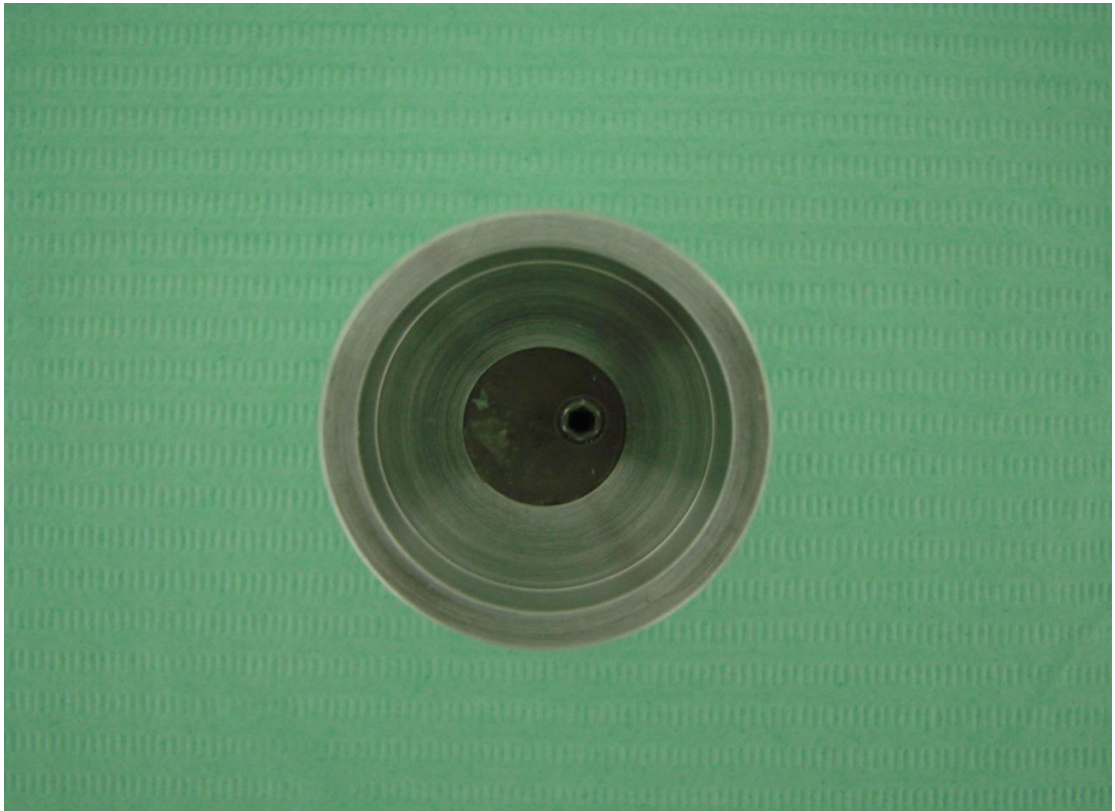
Fig.8 – Implante incluído em resina acrílica posicionado no cilindro de alumínio.
