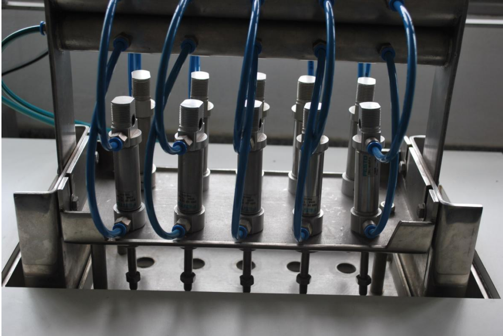
Fig. 23 – Base e pistões da máquina de ciclagem mecânica
