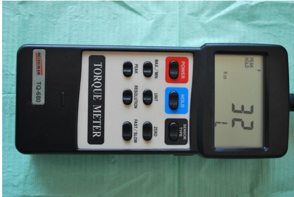
Fig.14 – Visor digital do torquímetro marcando 32N.cm
