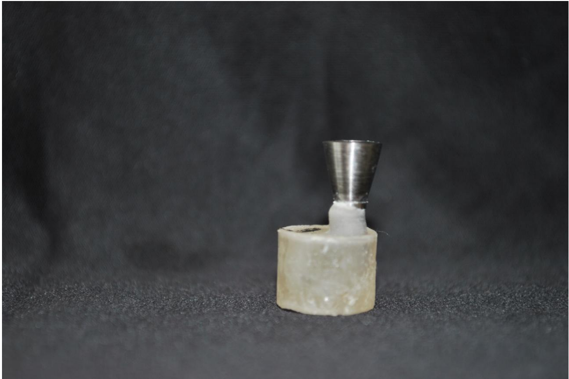
Fig. 7 - Conjunto pilar/implante incluído em resina acrílica
