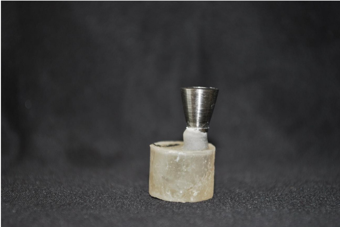
Fig. 20 – corpo de prova do grupo teste após ensaio de ciclagem
