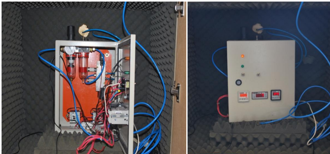
Fig. 22a e 22b – Mecanismo de regulação (caixa de comando) da máquina de ciclagem mecânica (à esq.); e visores de contagem da frequência e quantidade dos ciclos (à dir.)
