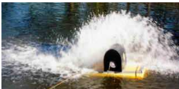
Figura 36. Aerador de superfície
