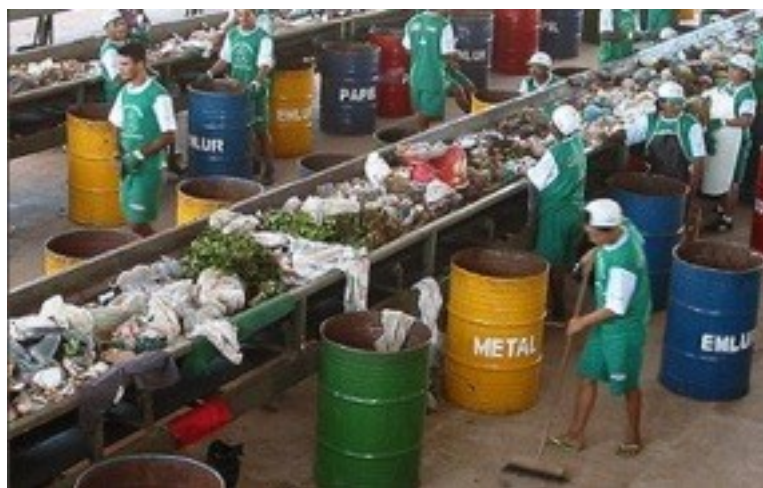
FIGURA 20 - USINA DE SEPARAÇÃO E TRIAGEM DE RESÍDUOS SÓLIDOS URBANOS
