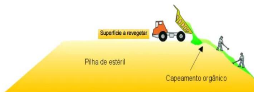
Figura 8 Recolocações da camada orgânica sobre a área a revegetar.
