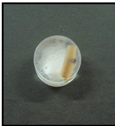
Figura 14 – Bloco obtido após a inclusão
