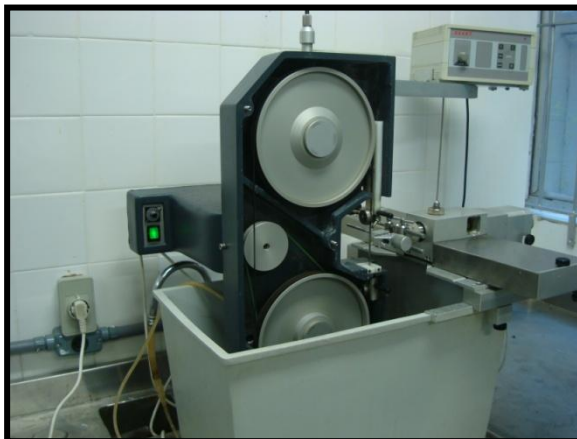
Figura 15 – Aparelho EXAKT® 300 CP utilizado para corte dos blocos
