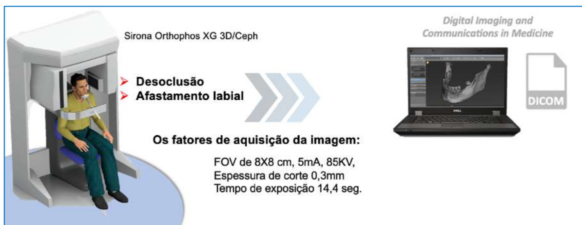
Figura 07: Esquema da sequência clínica para se obter o arquivo Digital Imaging and Communications in Medicine (DICOM) da tomografia.
