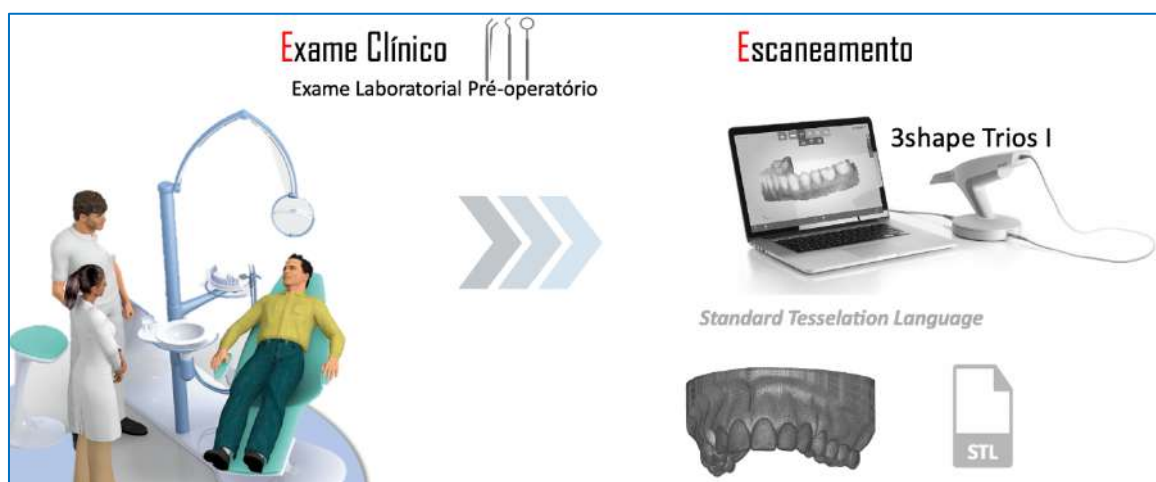
Figura 06: Esquema da sequência clínica para se obter o arquivo Standard Tessellation Language (STL) do escaneamento.
