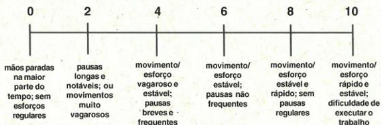
Figura 1 Escala análogo-visual para classificação de repetitividade a partir do movimento das mãos, com âncoras visuais (Latko et al., 1997).
