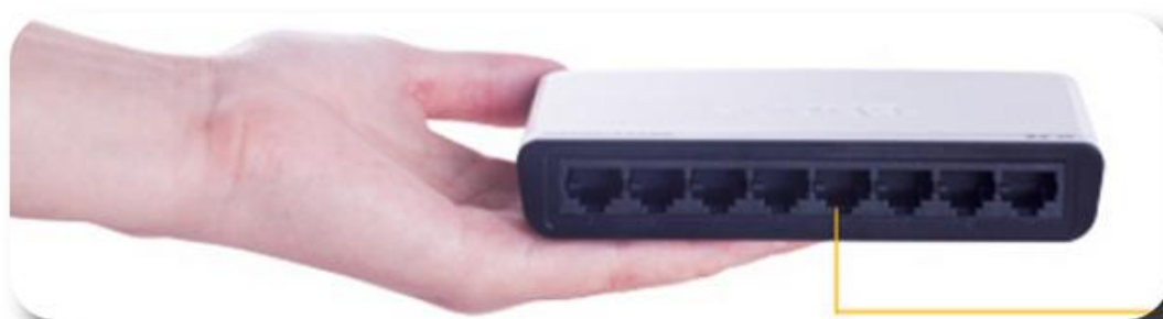
Figura 18 - Switch de oito portas utilizado nos testes
