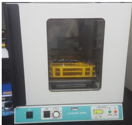
Figura 12 - tubos de amostras no agitador Orbital Shaker 211DS (Labnet, Edison, NJ, USA)
