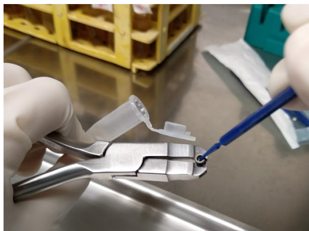
Figura 22 – esfregação no interior do implante com microbrush para remoção do conteúdo.
