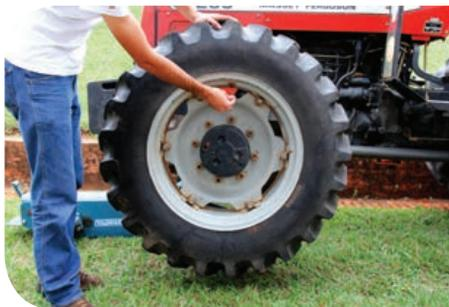
d. Coloque água no pneu.
