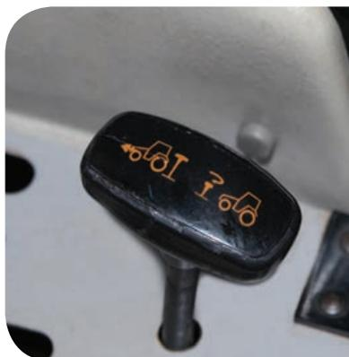
O acionamento eletro-hidráulico pode ser feito com a máquina parada ou em movimento, sem uso da embreagem.
