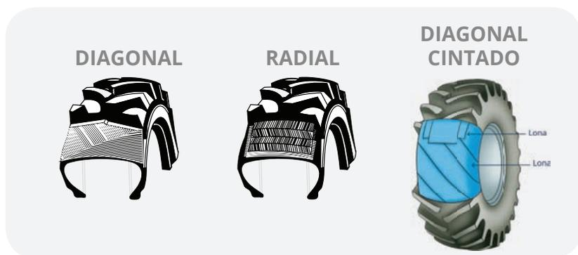
Os pneus **diagonais** apresentam lonas dispostas diagonalmente ao plano médio da banda de rodagem; as camadas se cruzam em ângulos menores que  $90^\circ$  o que favorece a rigidez dos flancos e da banda de rodagem.
