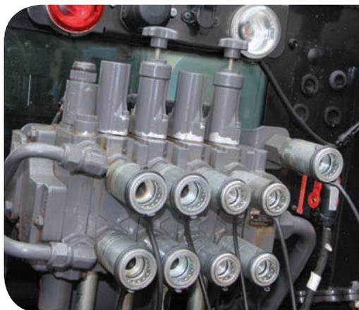
Algumas VCRs possuem em seu corpo um regulador de vazão para atender à demanda de óleo do cilindro ou motor hidráulico do implemento. Esta regulação é feita em uma manopla giratória, localizada na parte de cima da VCR e é indicada pelos símbolos tartaruga e lebre.
