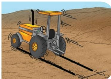
Em alguns modelos de tratores, mesmo com a tração desligada, ao acionar os pedais de freio de forma conjugada, a tração será automaticamente acionada, freando também o rodado dianteiro, garantindo maior eficiência e segurança da frenagem em transporte.
