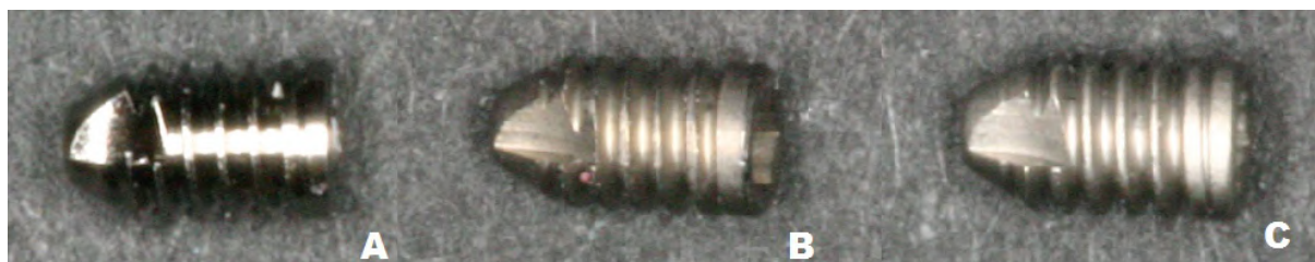
Figura. 4 - (A) Implante usinado; (B) Implante microtopografia; (C) implante nanométrico.
