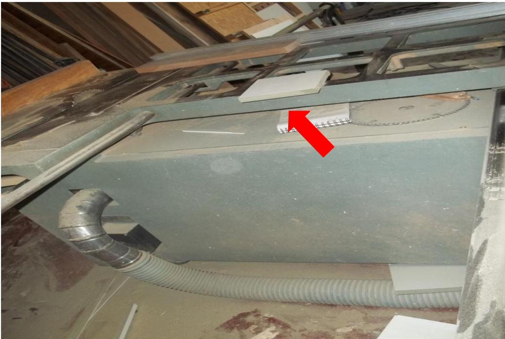
**Risco Mecânico:** Falta de organização e limpeza da máquina, podendo assim gerar um acidente de trabalho por um acúmulo de sujeira e peças soltas no interior da máquina.
