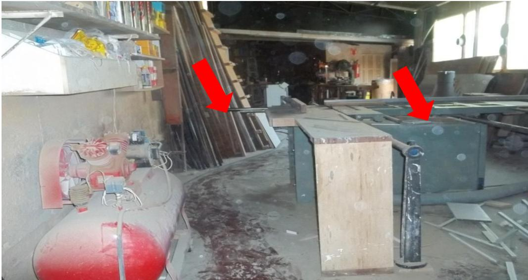
**Risco Mecânico:** Devido à poeira espalhada pelo piso, podendo assim ocasionar escorregões e deslizamento do trabalhador em seu período de atividade.
