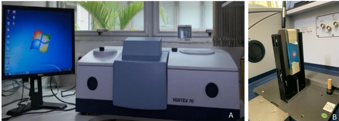
Figura 2- A) equipamento FTIR; B) corpo de prova em posição com feixe de laser centralizado.
