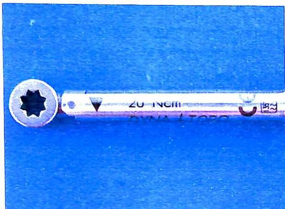
Figura 8: Torquímetro DynaTorq 20 Ncm
