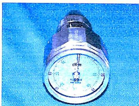
Figura 2: Aparelho calibrador Tohnichi
