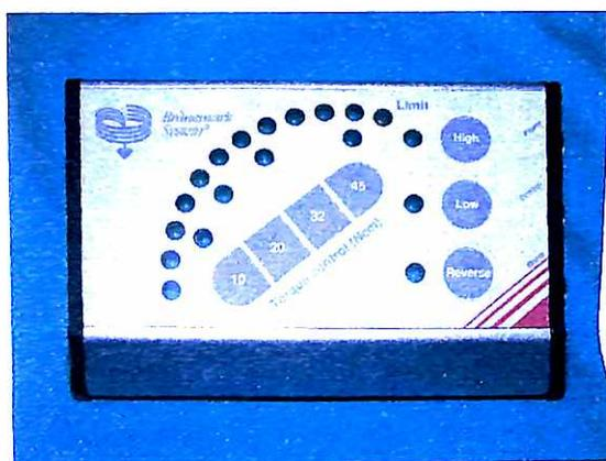
Figura 10: Torquímetro eletrônico Nobel-Biocare
