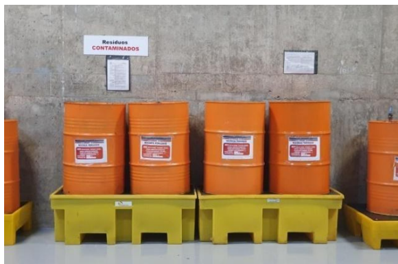
Figura 14 – Tambores para acondicionamento de Resíduos de O&M contaminados líquidos – situação em 2024
