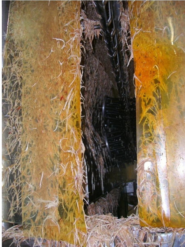
Figura 6: Máquina de depenagem, após processo de depenagem. Fonte: Arquivo Pessoal
