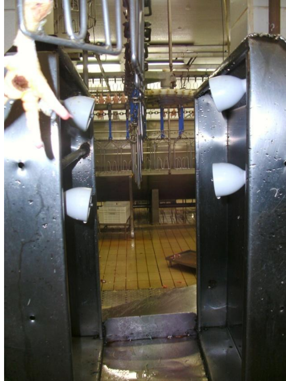
Figura 7: Chuveiros que lavam as carcaças antes de chegarem a área limpa Fonte: Arquivo Pessoal
