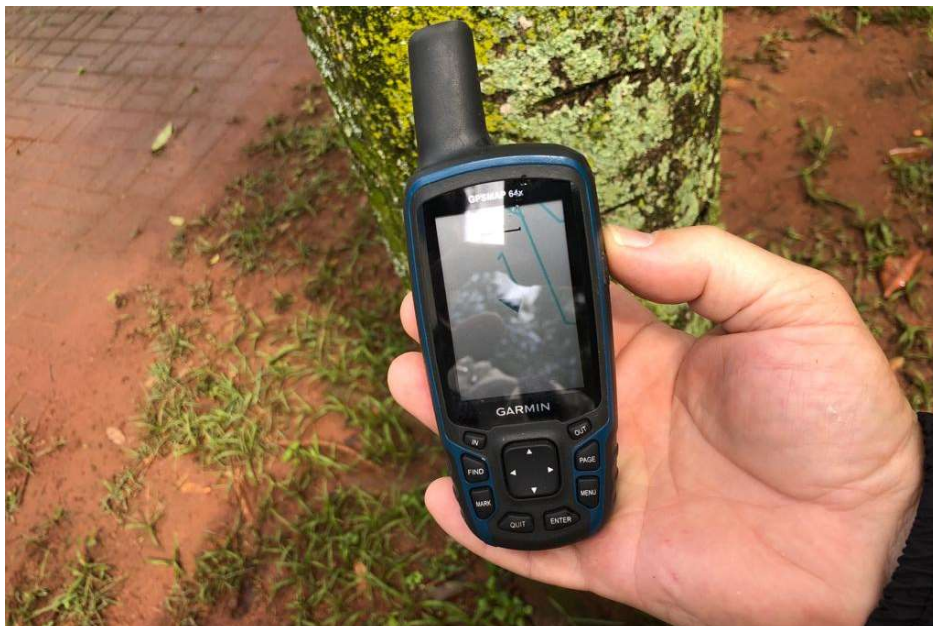
Figura 4 – Garmin GPSMAP 64x, utilizado para o georreferenciamento das espécies
