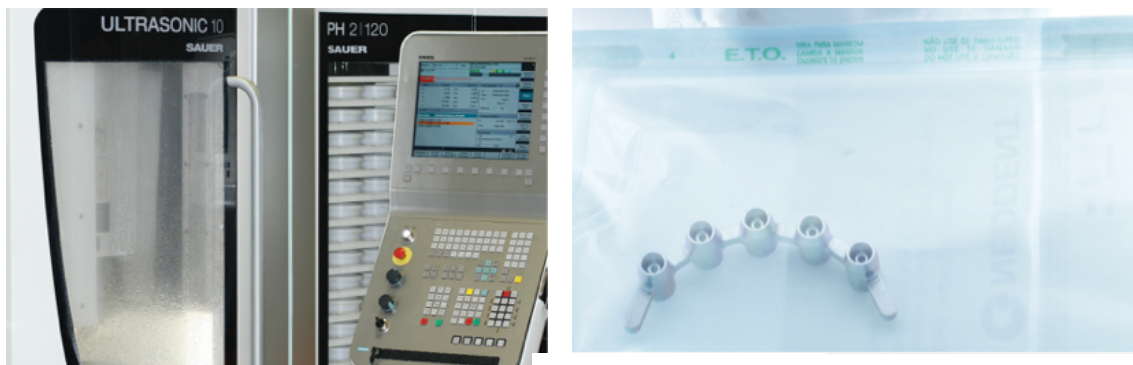
Figura 10. Etapa do CAM - Fresagem das peças. a) fresadora industrial; b) barra fresada
