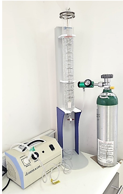
Figura 4 : Gerador de ozônio (Ozone & Life), conectado ao cilindro de oxigênio medicinal com regulador de fluxo e coluna de vidro utilizados para ozonizar a água.
