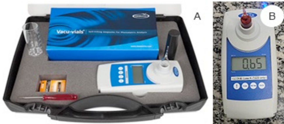
Figura 5: (A) Fotômetro e kit colorimétrico utilizado na pesquisa. (B) Confirmação da concentração do ozônio na água.
