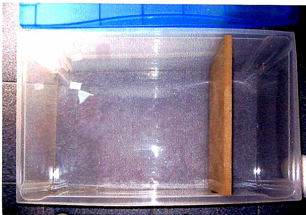
Figura 2: Caixa para a inalação da fumaça do cigarro (vista superior).
