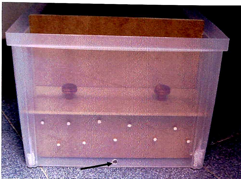
Figura 7: Compartimento instalado, vista frontal da caixa. Note a presença do orifício para entrada da mangueira de ar (ponta da seta).
