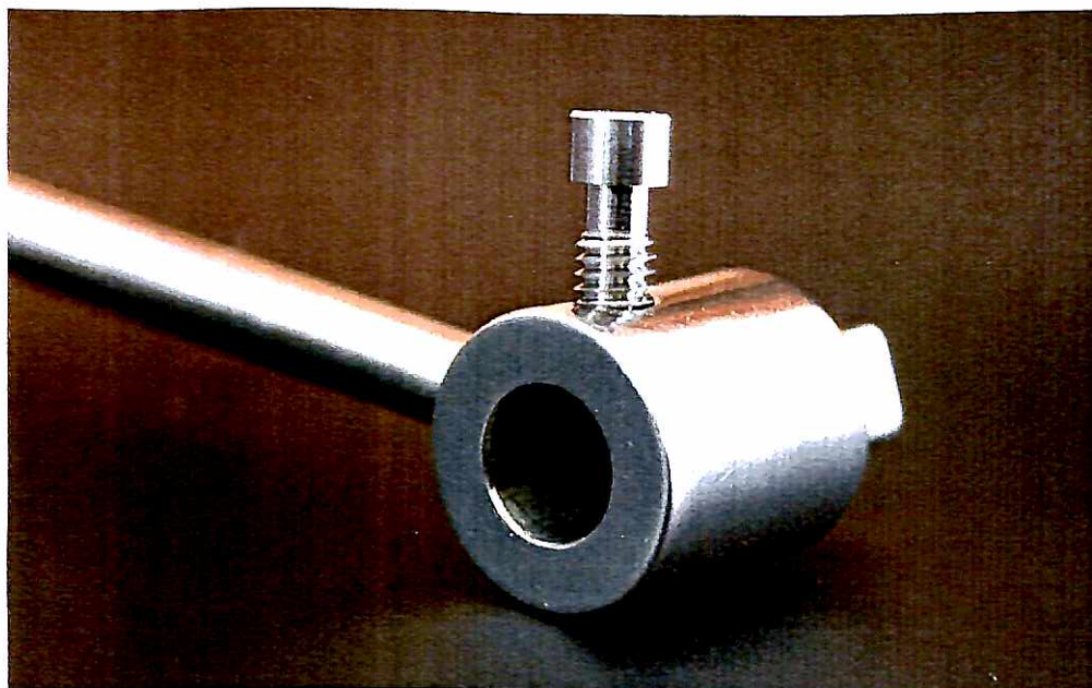
Figura 33: Suporte para fixação dos pilares, observar o parafuso de travamento horizontal
