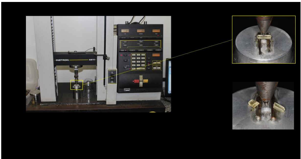
Figura 6 – teste de resistência em máquina de ensaio universal (INSTRON mod. 4411 Canton, AM, EUA)
