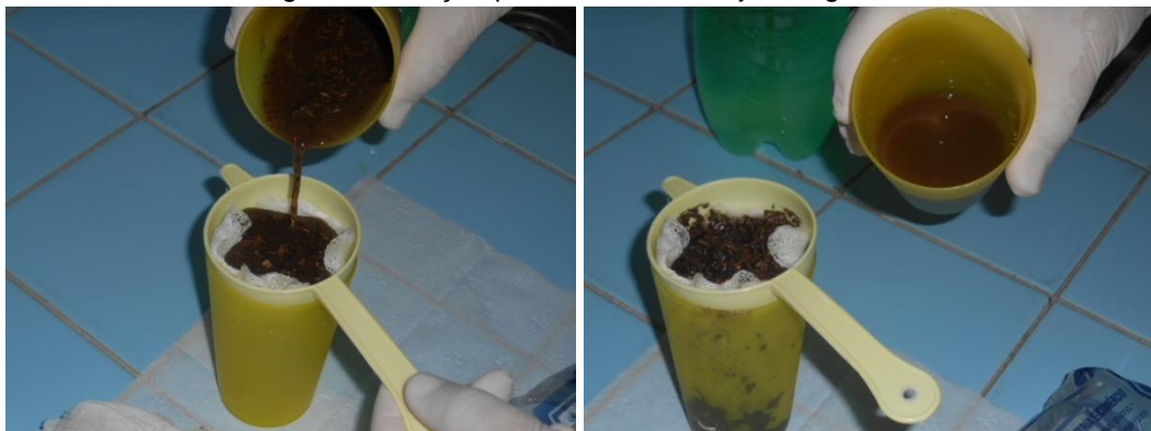
Passagem da solução para os beakers; formação de menisco
