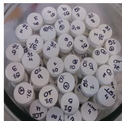
Em seguida as amostras serão armazenadas individualmente em 5 ml de água destilada a 37°C, por sete dias.
