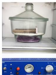
Após 24 h da confecção dos corpos-de-prova, os mesmos foram armazenados em um dissecador (37°C) contendo sílica gel, mantidos em sala com temperatura e umidade controladas.
