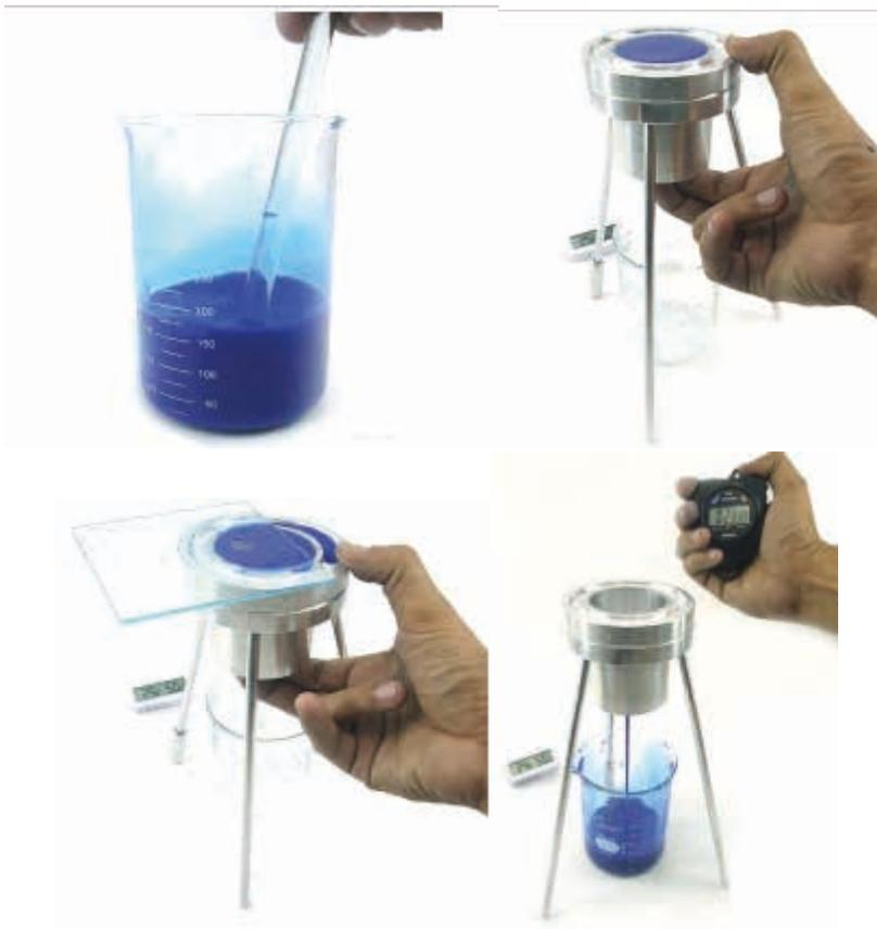
Figura 1: Medição prática de viscosidade em viscosímetro copo e ford
