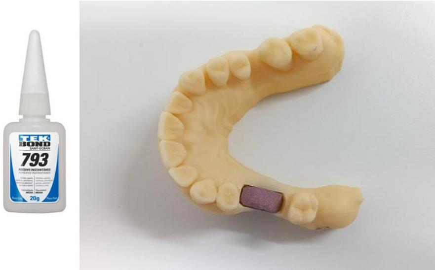
Figura 5 – Corpo de prova incorporado no nicho através de colagem, com cola a base de cianoacrilato (TEKBOND®). Fonte: Autor (2023).
