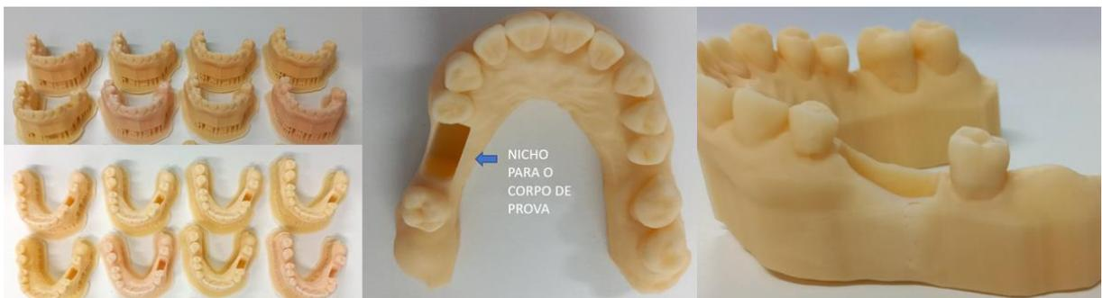
Figura 2- Modelos em resina obtidos por impressão 3D, com nichos. Fonte: Autor (2023).
