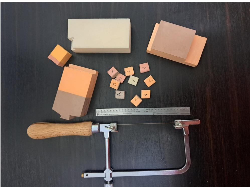
Figura 4 - Corpos de prova customizados com serra de ourives. Fonte: Autor (2023).
