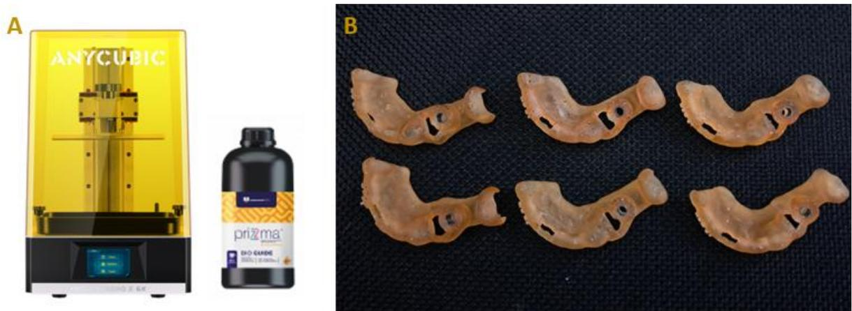
Figura 10- A - Impressora 3D Anycubics Photon Mono X 6K e resina Prizma 3D Bio Guide LCD. B – Guias cirúrgicos impressos. Fonte: Autor (2023).
