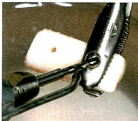
Figura 05: Perfuração do bloco para passagem dos parafusos de fixação
