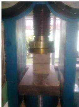
Figura 5. Ensaio de compressão
