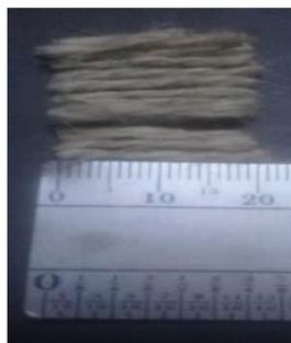
Figura 2. Fibras de malva com 2 cm de comprimento.
