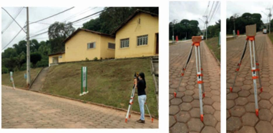
Figura 2 – Leitura da distância para o alvo prisma, tijolo e bloco de concreto
