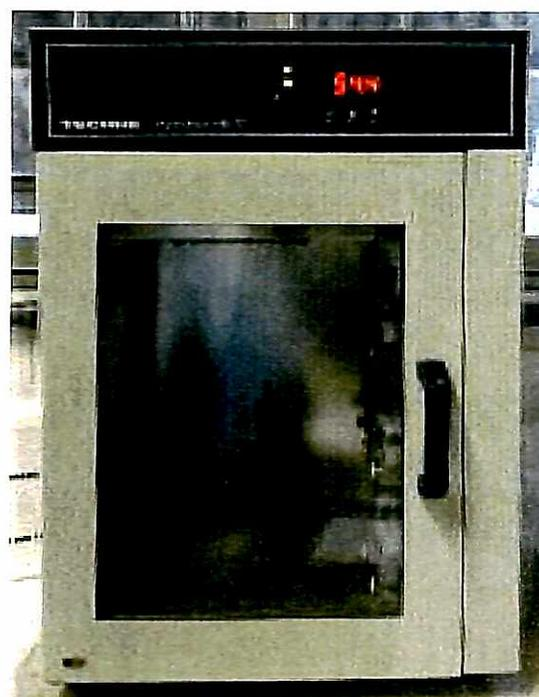
Figura 9 - Estufa utilizada para a secagem.
