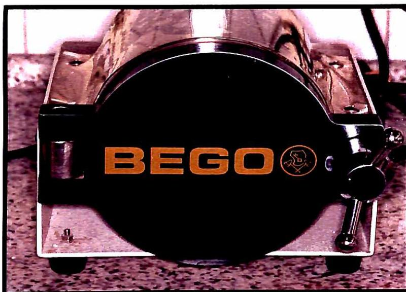
FIGURA 7 - Câmara pressurizadora para dissolução de bolhas
