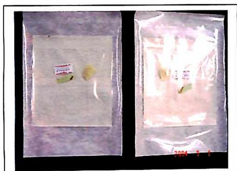
Fig. 9 – Aspecto da poliuretana esterilizada a óxido de etileno.
