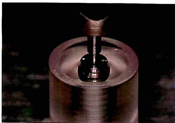
Figura 8 – Nivelamento do implante Ankylos ® na altura do cilindro de PVC contendo a resina.
