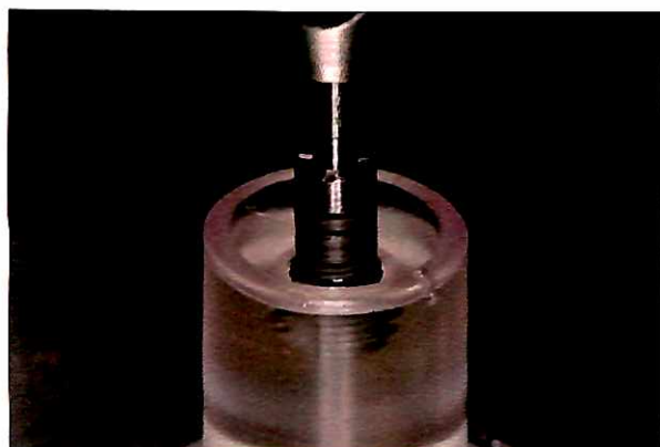
Figura 7 – Inclusão do implante Ankylos ® no cilindro de PVC contendo a resina.
