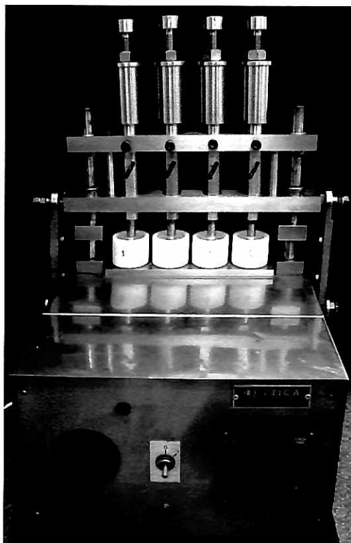
Figura 20 – Máquina de ciclagem mecânica e amostras distribuídas em grupos de quatro.
