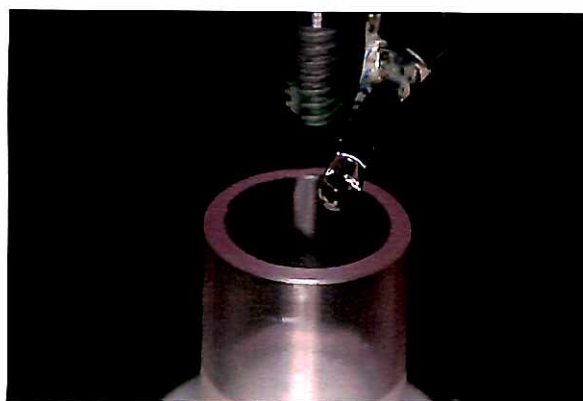
Figura 6 – Preenchimento do cilindro de PVC com a resina.
