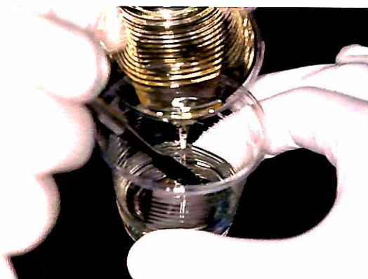
Figura 5 – Manipulação da resina araldite GY 279 BR e do endurecedor HY 2963 BR.
